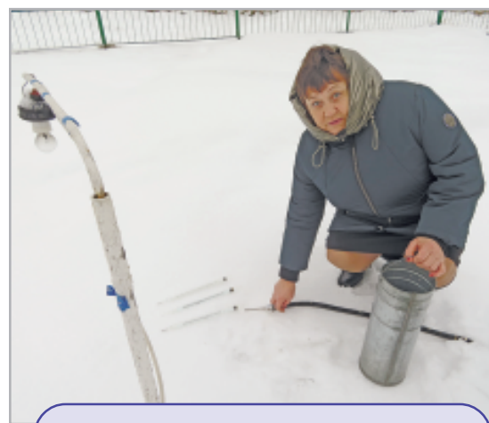
С помощью этих термометров Валентина Ерошенкова определяет температуру воздуха и почвы.
