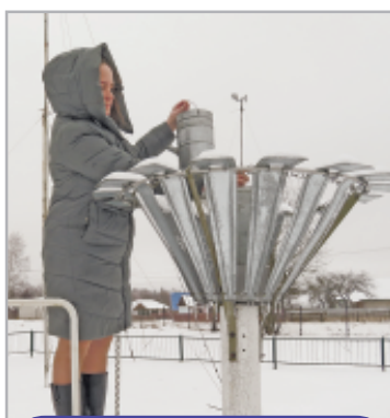
С помощью мерных стаканчиков-осадкомеров четыре раза в сутки определяют количество выпавших осадков. Наблюдение ведет метеоролог Ольга Щигельская.
