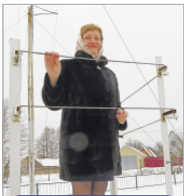
На снимке старший техник Оксана Сидорова. Гололедный станок предназначен для измерения гололедно-изморосевых отложений. Если перила замерзают, то метеорологи отправляют в область телеграмму, что в районе неблагоприятное погодное явление - гололед.
